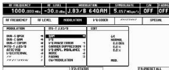
Bild 5.35 Das R&S SFQ Menü zur J.83B-Parameter-einstellung
